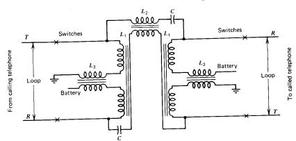
Figura 2.2 Circuito alimentado a batería - Nota: La batería y la tierra se alimentan a través de los inductores L2 y L1, a través del conmutador a los lazos de abonado (Circuito de Bell Laboratorios)
