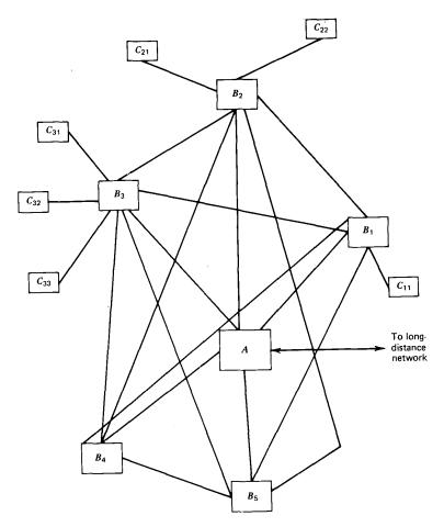
**Figura 1.11** Red telefónica típica que sirve una ciudad pequeña como ejemplo de un compromiso entre la red mesh y la configuración de estrella.
