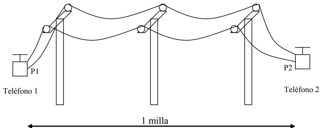
El circuito (par de alambres que vinculan a los dos teléfonos de la figura), está realizado con alambre de cobre calibre N° 19 Brown & Sharpe (equivale a un diámetro de 0,912 mm), cuyas características son:
